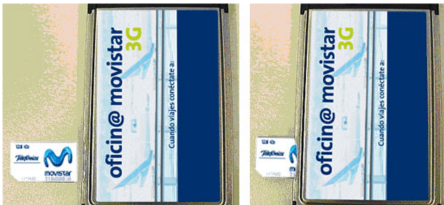
Figura 4. Insertar la tarjeta SIM en la Tarjeta Internet Móvil.
